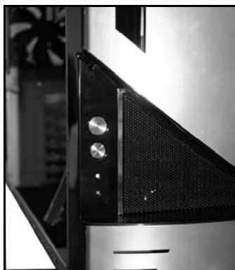
Emplacements de la LED du disque dur, de la LED d'alimentation et de la réinitialisation sur la face avant
